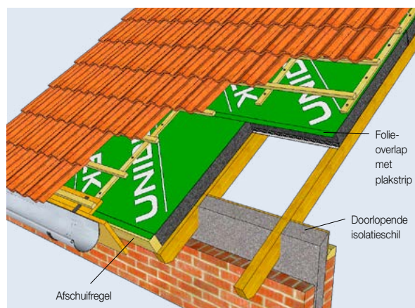
Figuur 1 Detail plaatsing dakelementen
