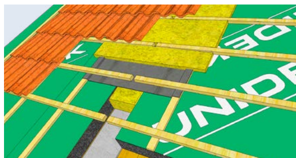
Figuur 7 Detail woningscheidende wand met passtrook
